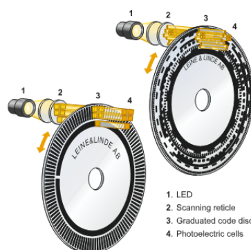
Figura 9 – Encoder Óptico
