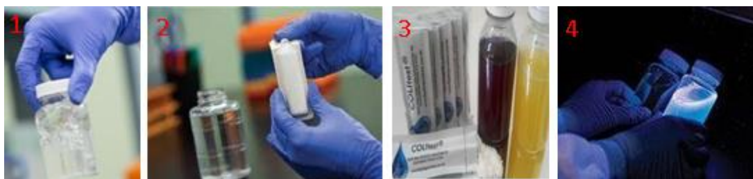
Figura 07 – Ilustração de forma de uso do Colitest para a análise microbiológica de coliformes totais e Escherichia coli para água potável
