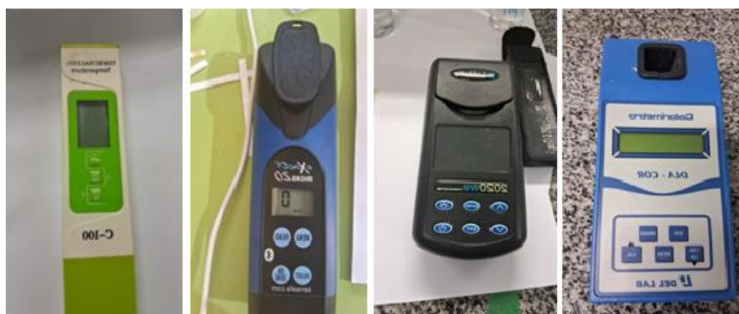
Figura 04 – Equipamentos utilizados para a análise físico-química em alguns poços visitados na pesquisa.
