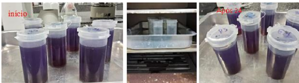
Figura 05 – Análise microbiológica em frasco de PET (100 mL), incubado com substratocromogênico.
