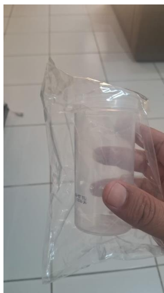
Figura 02 – Frasco de plástico de Polietileno, esterelizado (1000ml) para análise microbiológica
