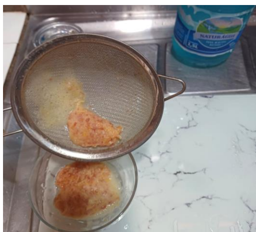
Figura 6: Primeira etapa de filtração, com peneira de material inox.
