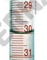
**Figura 8** O volume da solução ácida que foi entregue pela bureta pode ser lido, ao final da titulação, na escala da bureta. No exemplo da foto, o volume foi 30 mL. Essa leitura é feita respeitando o que está indicado na Figura 5.
