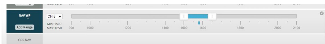
Figura 1 – Modo waypoint sendo definido no canal 6 do rádio, o slider apresenta o intervalo definido para o modo de voo.
