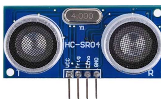
Figura 17: Sensor de distância ultrassônico.
