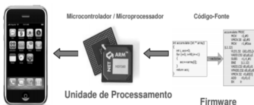
Figura 2 – Funcionamento de um sistema embarcado
