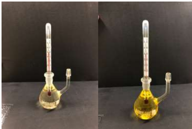
Figura 8 - A: Picnômetro cheio com biodiesel de óleo puro. B: Picnômetro cheio com biodiesel de óleo de fritura reutilizado.
