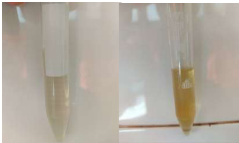
Figura 7 - A: Biodiesel produzido do óleo de soja puro. B: Biodiesel produzido a partir do óleo de soja de fritura.
