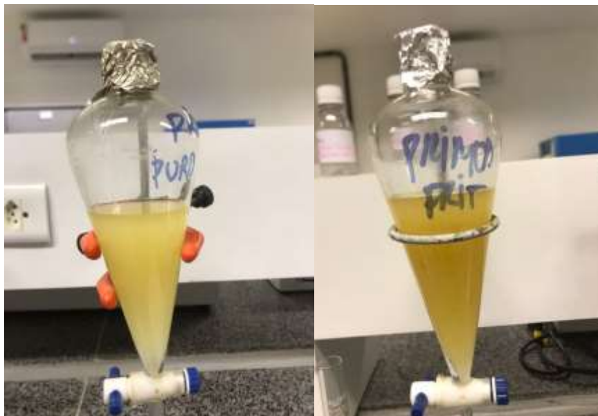
Figura 6 - A: Separação do óleo puro e glicerina. B: Separação do óleo de fritura e glicerina.
