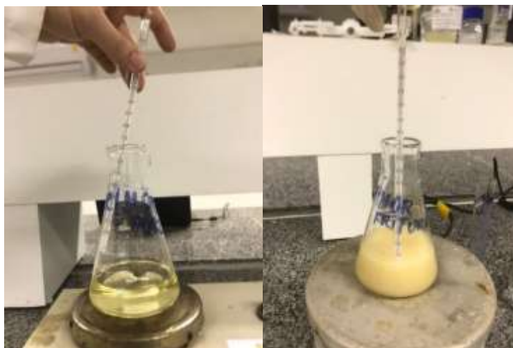
Figura 5 - A: Estabilização da solução de etóxido de sódio do óleo puro. B: Estabilização da solução de etóxido de sódio do óleo de fritura reutilizado.
