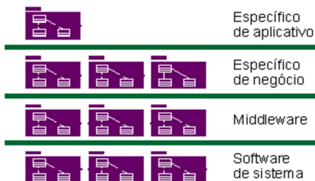
Figura 4 – Arquitetura de software baseada em componentes
