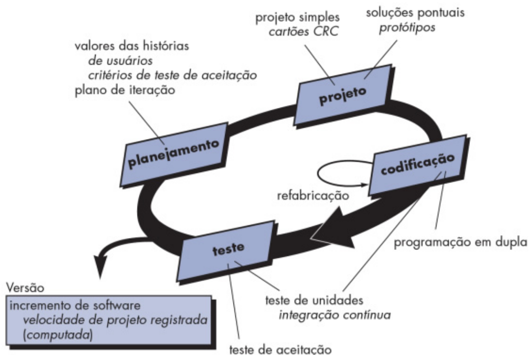
Figura 5 – O processo de Extreme Programming
