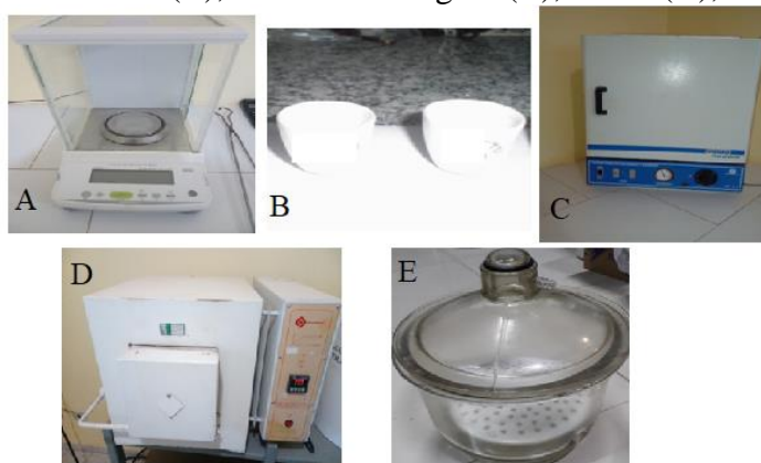
Figura 12: Material utilizado para análise de matéria orgânica de solo: Balança Analítica (A), Cadinho de Porcelana (B), Estufa de secagem (C), mufla (D), disseccador (E)
